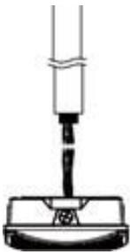
1. Connectez le câblage à l'alimentation locale dans les connexions de tige filetée NPT 3/4 po comme décrit dans la section Schéma de câblage.
